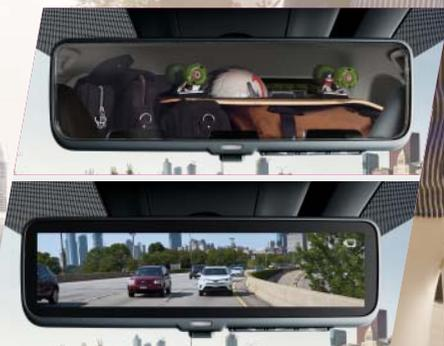
*Con el nuevo retrovisor inteligente\*, los conductores pueden ver mejor lo que les rodea. Con solo pulsar un botón, el retrovisor interior electrocromático con regulación automática se convierte en un monitor digital de alta definición. Además, por medio de una cámara montada en la parte superior de la luna trasera del RAV4, el monitor garantiza en todo momento una vista despejada, incluso cuando hay objetos voluminosos en el maletero.*
