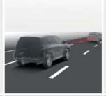
Control de Crucero Adaptativo (ACC) El Control de Crucero Adaptivo va más allá del control de crucero convencional. Este sistema mantiene la distancia y velocidad con el vehículo que le precede, gracias a un control constante de velocidad.
